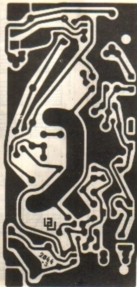
Figura 3. Placa impresa (lado cobre)
